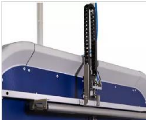
Пневматично задвижвани притискащи модули - гарантират правилното стабилизиране на продукта по време на работния фолиращ цикъл
